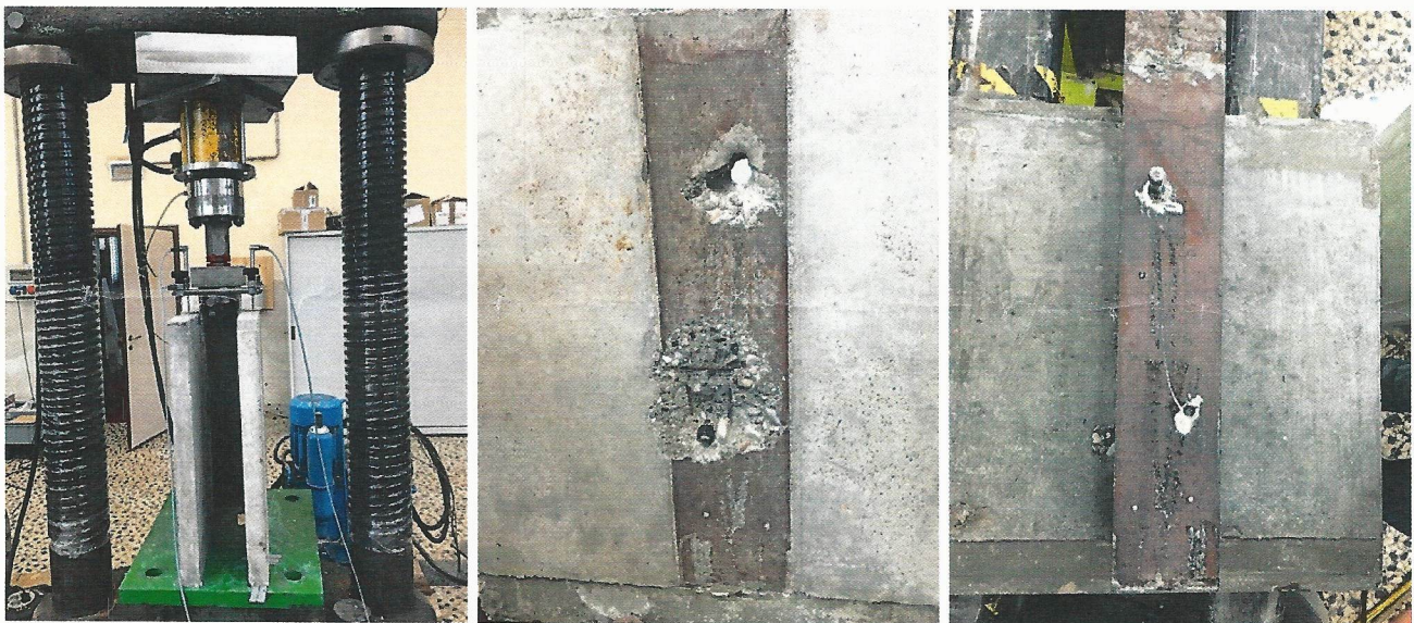
Figura 6 Set-up di prova e modalità di rottura del campione 1
